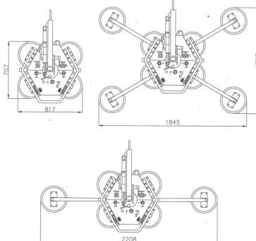
Max. Tragkraft (erweitert): 600 kg
