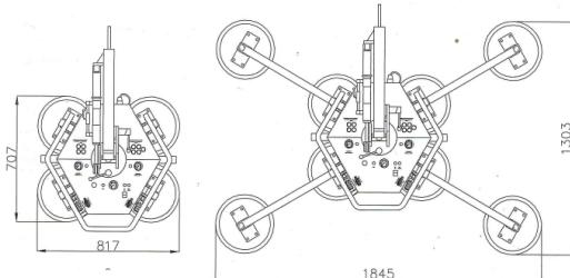
Max. Tragkraft (erweitert): 600 kg
