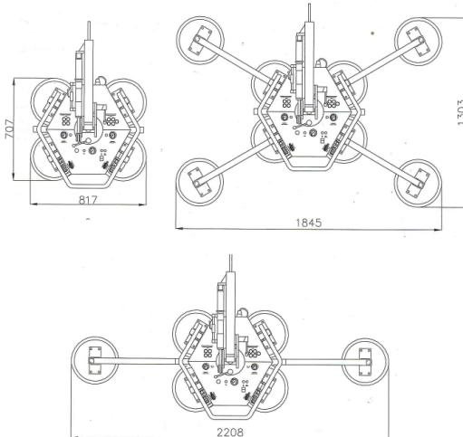
Max. Tragkraft (erweitert): 600 kg
