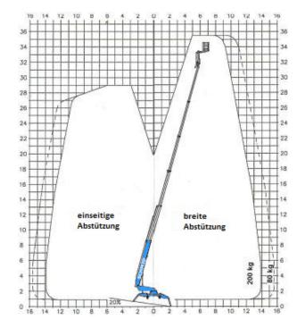
Markierungsfreie Ketten 230 V Steckdose im Arbeitskorb Automatische Abstützung Bei Betrieb mit Notstrom-Aggregat min. 10 kW
